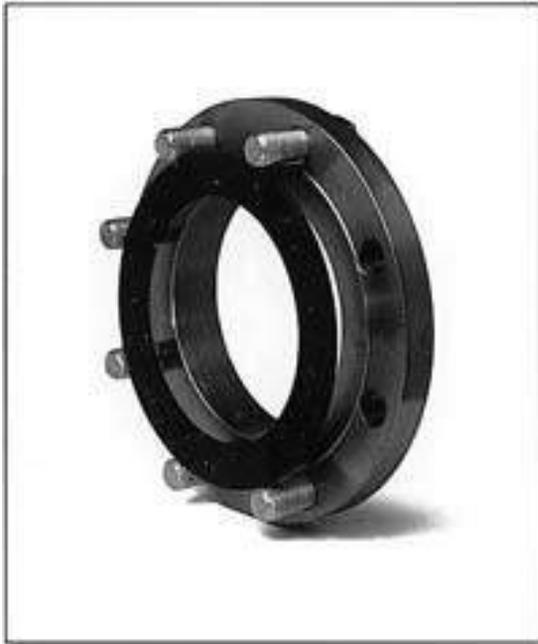
Mosites proporciona un sello positivo en el empaque, y no se dobla en la Instalación. El diámetro exterior, es el mismo que el círculo formado por el perno de la brida, de esta manera Mosites asegura el recubrimiento del empaque, al ser propiamente alineado, cuando se une.
